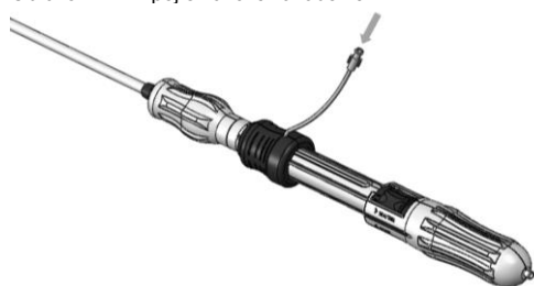
Obrázok 14: Pripojte tlakové zariadenie
