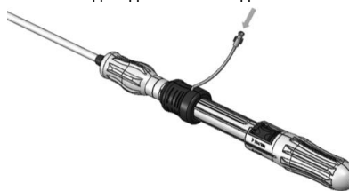
Рис. 14: Подсоедините линию давления
