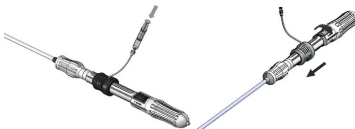
Рис. 14: Подсоедините линию давления
