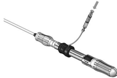
Εικόνα 14: Συνδέστε τη γραμμή πίεσης
