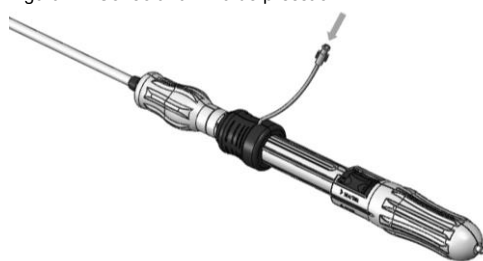
Figura 14: Conectar a linha de pressão
