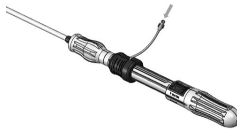
Εικόνα 14: Συνδέστε τη γραμμή πίεσης
